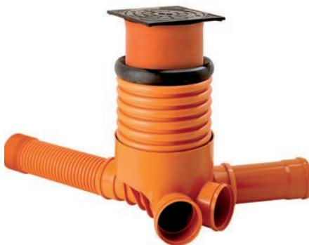
Na imagem é apresentado um exemplo de uma caixa de ramal completa, constituída por base, tubo de elevação e camisa telescópica completa (com junta telescópica em EPDM e tampa em FFD).
