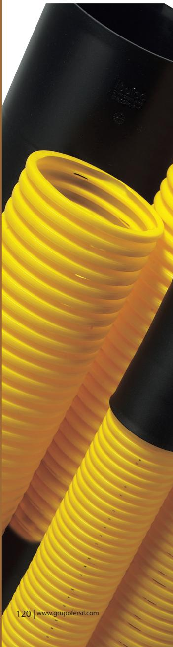
A Ibotech apresenta um conjunto de tubos perfurados em Polietileno, de elevada robustez, com uma rigidez círcunferencial SN2 (superior a 2 kN/m<sup>2</sup>) e SN4 (superior a 4 kN/m<sup>2</sup>), aplicado em condutas subterrâneas de drenagem pluvial sem pressão, conforme com a norma UNE 53994.
